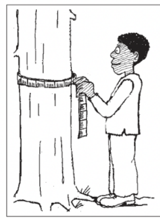
図 胸高直径の測定 GLOBEバイオメトリープロトコルより引用
